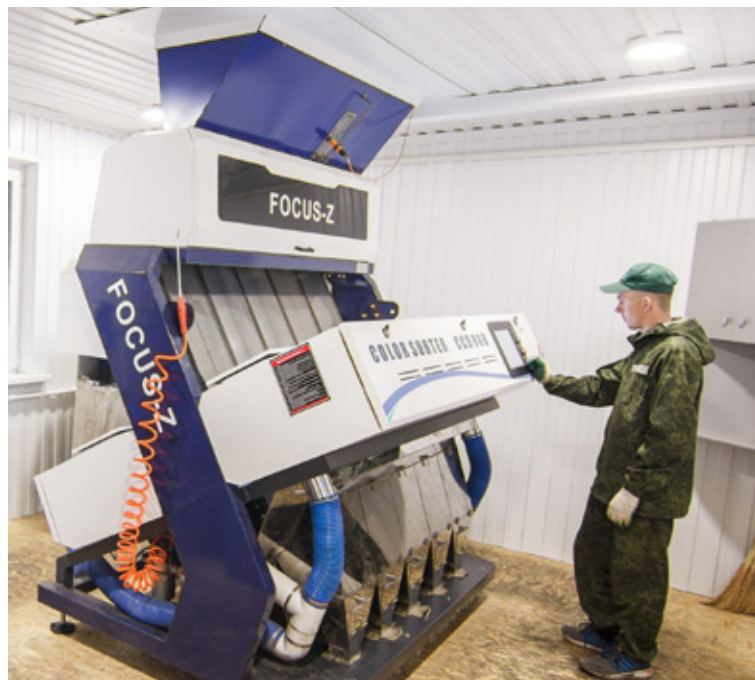
Работают три линии очистки семян с использованием оптических сортировщиков, которые позволяют добиваться 99,9% чистоты продукта.
